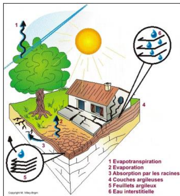
Figure 3 : Conséquence des gonflements et rétractations sur une habitation
